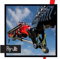
HMF ofrece varios tipos de Fly-Jib. Es posible llevar un cabrestante sobre el Fly-Jib. Se pueden equipar las grúas de HMF con válvulas extra, posibilitando p.ej. el montaje de bivalba de arena en el Fly-Jib.
